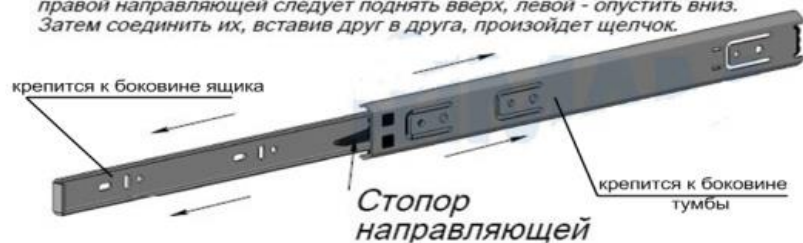
Рис.5 Схема установки шариковых направляющих
